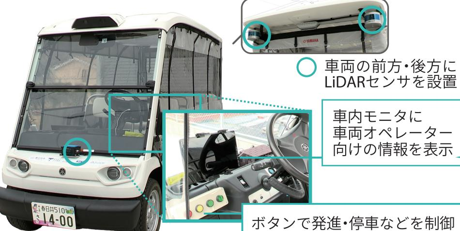
低速走行(約15km/h) 中っくり 自動運転 Slocal Autonomous Driving
